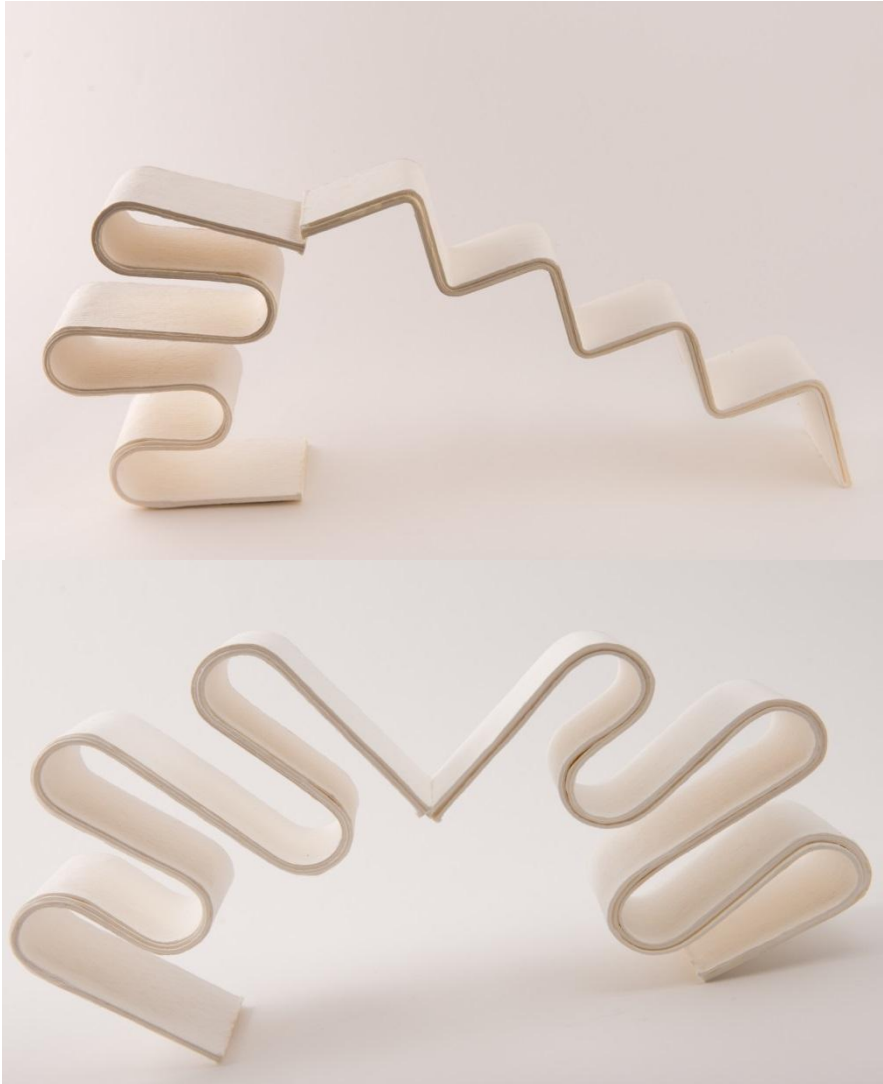
Moldable pure cellulose pulp sheets Design: Tomi Laukkanen LAMK Materials: Metsä Group Photos: Juha Hakulinen VTT
